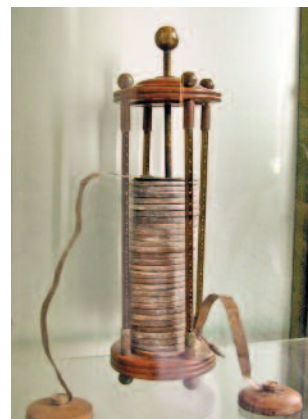
La première pile de Volta
